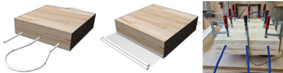
Abb. 8.01 Links sowie mittig zwei schematische Darstellungen der Untersuchungsvarianten und rechts ein Bild des ersten Prototyps aus Brettsperrholz für die weitere messtechnische Untersuchung
